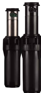
I-25-04 Altura total: 20 cm Altura de elevação: 10 cm Diâmetro exposto: 5 cm Tamanho da rosca: 1" BSP
