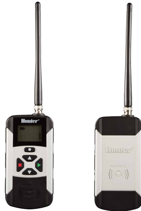
Roam XL (especificações sem antena) Altura: 16 cm Largura: 8 cm Profundidade: 3 cm
